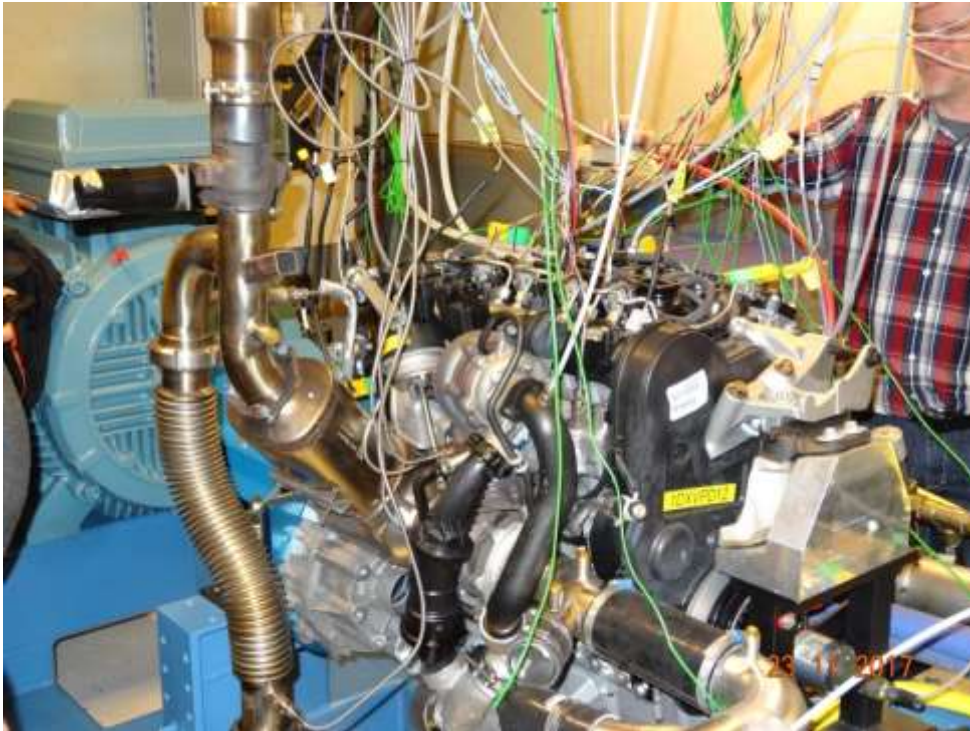
En standard 4-cylindrig Volvo diesel som kördes på bensin med högre effektivitet som resultat (prova inte själv hemma. Det är svårare än det låter)
